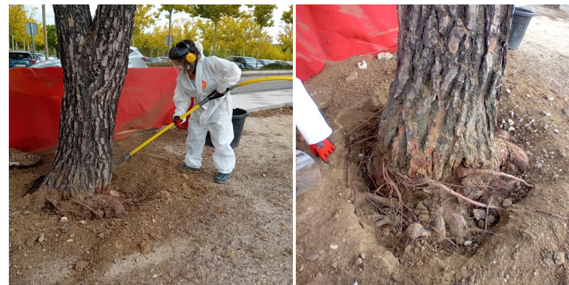
Fig. 25: Air spade y resultados obtenidos.
