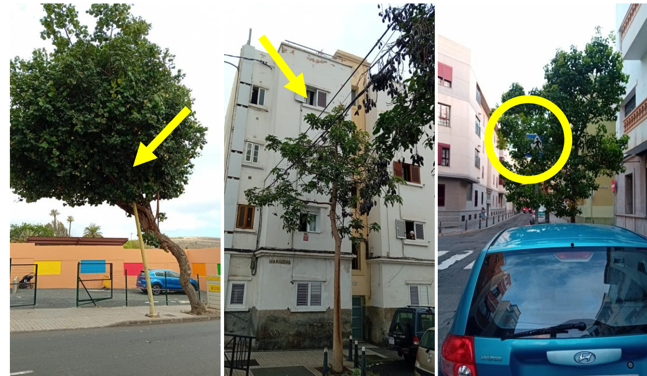
Fig. 33: Interferencias del arbolado con elementos urbanos. Fuentes: Elaboración propias en el municipio de Las Palmas de Gran Canaria: Imagen 1: farola incluida en la copa de un ejemplar arbóreo. Imagen 2: árbol muy podado en contacto con cableado aéreo. Imagen 3: Señal incluida en una copa, y sin visibilidad.
